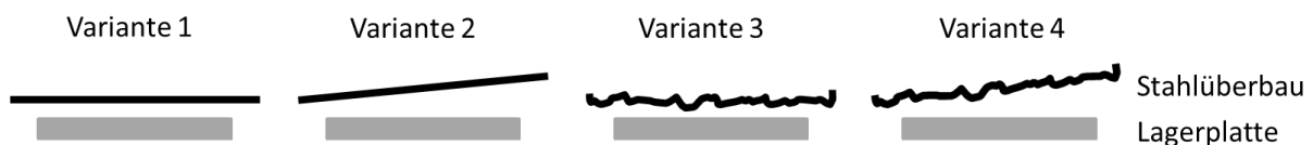
Abbildung 12: Typische Varianten der Lagereinbausituation am Stahlüberbau
