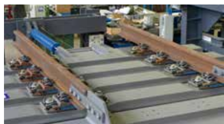
Junta de traviesa guiada de MAURER en el laboratorio de pruebas
