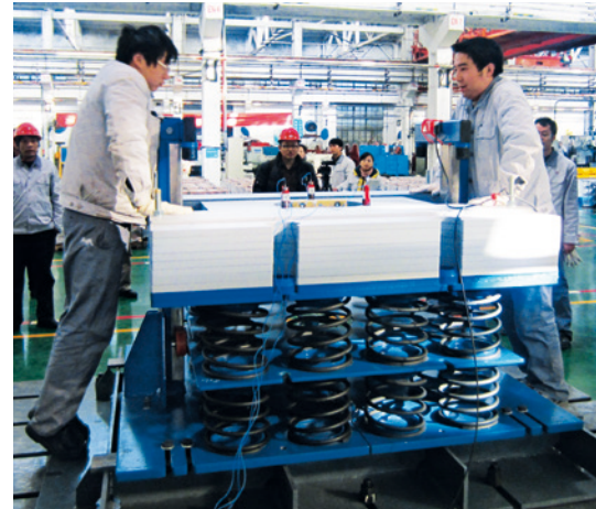
Test eines originalen Schwingungsdämpfers für das am Deep Water Viaduct im Testlabor in Wuhan. Er zeigte exakt das geforderte Frequenz- ( \pm 1\% ) und Dämpfungsverhalten ( \pm 10\% ).
