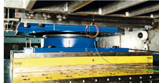
Gleitpendellager im Teststand in Pavia. Sie übertragen Vertikallasten von bis zu 40 MN.
