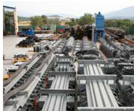
Unterschiedliche Ausführungen von Fahrbahnüberhängen vor der Auslieferung
