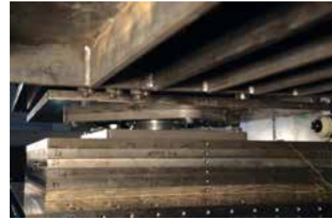
Versuchsaufbau des SIP®-Adaptive am EUCENTRE in Pavia
